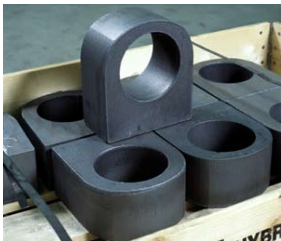
Pièces brutes d'oxycoupage pour corps de palier.
